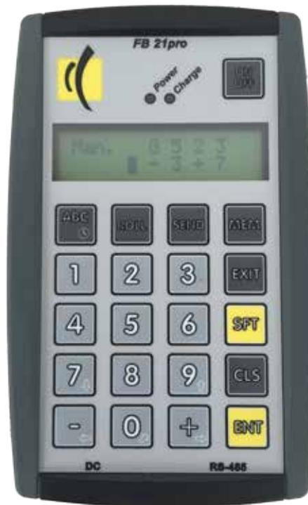
Mikroprozessorgesteuertes, bedienungsfreundliches Funk-Bedienteil mit digitalen Speicherplätzen und LCD-Display. Es können beliebig viele Tafeln mit einem oder mehreren Bedienteilen angesteuert werden. Die Eingabe erfolgt drahtlos von jedem beliebigen Standort im Raum. Zusätzliche, störende Verkabelungen sind nicht mehr erforderlich!
